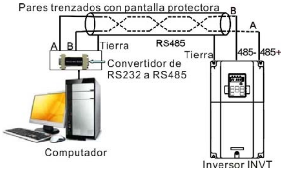
Figura 1 Conexión física RS485 en aplicación única
