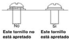
Fig 4-17 Instalación correcta del tornillo
