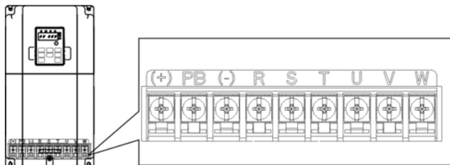
Fig 4-4 Terminales del circuito principal
